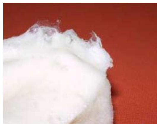
Obr. 2: Napenenie zálievky MEYCO® MP 350 po reakcii s vodou.
