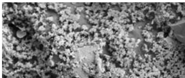
Kryoskopický snímok X-SEED® zhotovený elektrónovým mikroskopom (CryoSEM): Aktívne kryštály rastúce medzi cementovými zrnami
