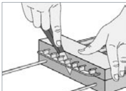
Masterflex® 2000 pás odrežte v zváracom prípravku
