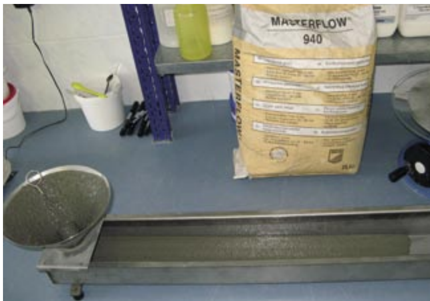
Prietokový zľab - zariadenie na skúšku tekutosti zálievok
